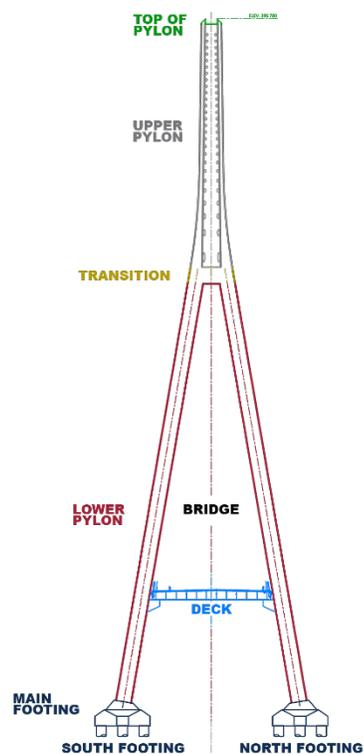
La construction des semelles de la travée du pont et des piliers d'ancrage est également en cours sur les deux sites. Il y a six fondations et piliers d'ancrage de chaque côté de la frontière qui soutiendront la structure principale du pont au-dessus de la rivière.
